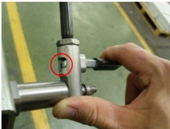
Bild 1: Zylinderkraft wirkt (entriegelt)
