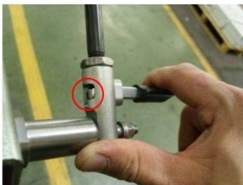
Bild: Zylinderkraft wirkt (entriegelt)
