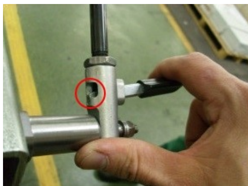
Bild: Zylinderkraft gesperrt (verriegelt)
