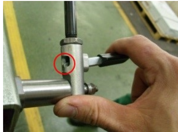
Bild 2: Zylinderkraft gesperrt (verriegelt)
