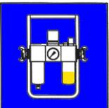
Achten Sie darauf, dass die Druckluftantriebe immer ausreichend und mit dem richtigen Öl versorgt werden!
