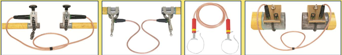
Vor dem Trennen oder Verbinden von metallischen Erdgas- und Wasser-Rohrleitungen sind diese elektrisch zu überbrücken. Diese Maßnahme ist zur Vermeidung von elektrischen Berührungsspannungen und damit gefährlicher Körperströme bei elektrisch leitenden durchgehenden Rohrleitungen erforderlich.
