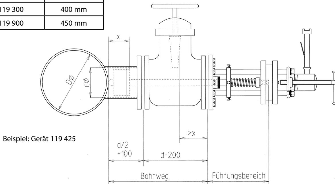
**Berechnungsbeispiel:** benötigte Bohrstangenlänge für eine Anbohrung DN 150 mit dem Anbohrgerät 119 425
